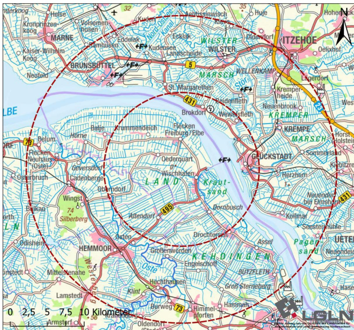
**Abbildung 16:** Bereich im Radius der 50- bis 100-fachen Anlagenhöhe und damit von 10,5 bis 21 km im Umkreis des Bebauungsplanes, für den sich eine Fernwirkung gem. NLT (2014) für die drei ca. 210 m hohen Windkraftanlagen ergibt. M 1 : 300.000.
