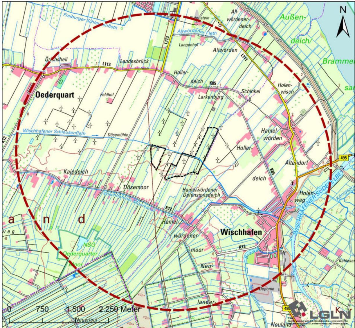
**Abbildung 21:** Untersuchungsgebiet Landschaftsbildanalyse unter Berücksichtigung von drei geplanten WEA mit einer Gesamthöhe von maximal 210 m. M 1:50.000.
