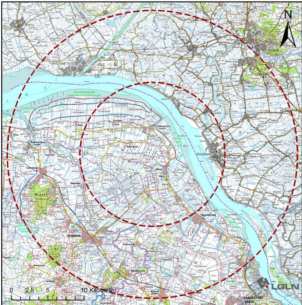
**Abbildung 3:** Bereich im Radius der 50- bis 100-fachen Anlagenhöhe und damit von 10 bis 20 km im Umkreis des Bebauungsplanes, für den sich eine Fernwirkung gem. NLT (2014) für die 2 ca. 207 m hohen Windkraftanlagen ergibt. Maßstab 1: 250.000.
