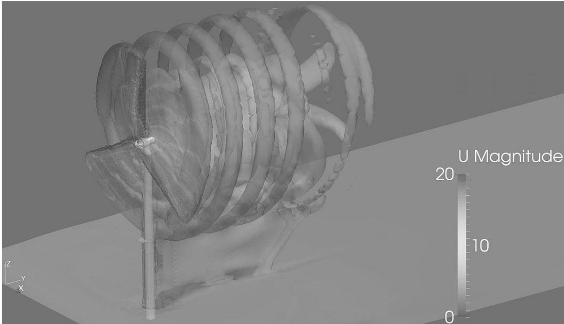
**Abb. 6-4: Turbulenzhelix einer Windkraftanlage im particle image velocimetry Experiment**
