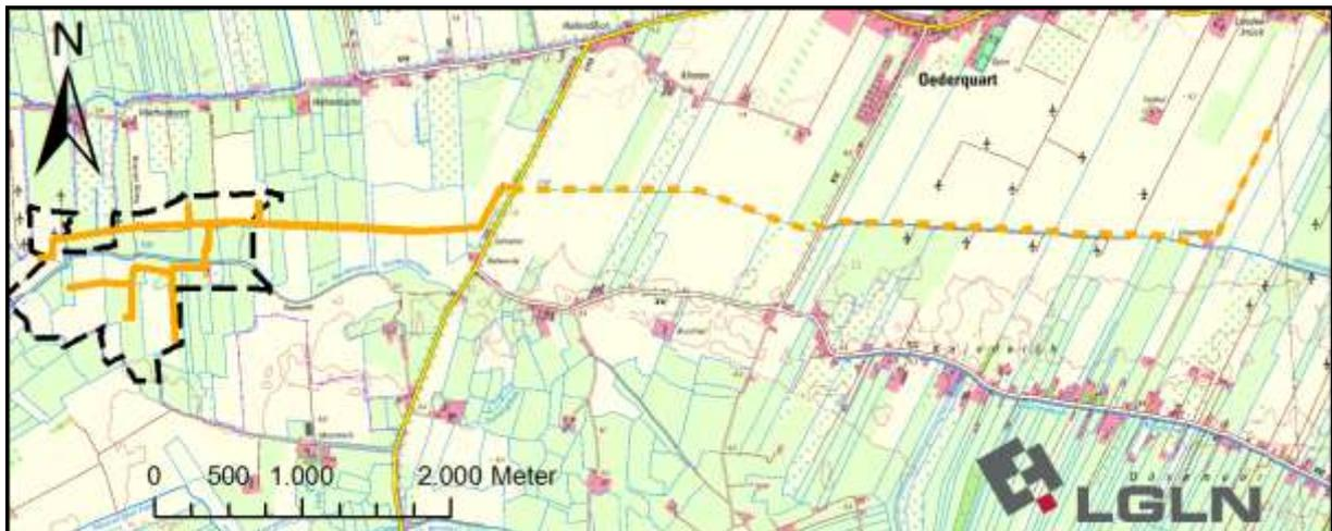
**Abbildung 3:** Verlauf der Leitungstrassen im Plangebiet und bis zur Gehrener Sietwende (gelb) sowie bis zum Umspannwerk am Freiburger Weg (gelb gestrichelt). Maßstab 1:50.000.
