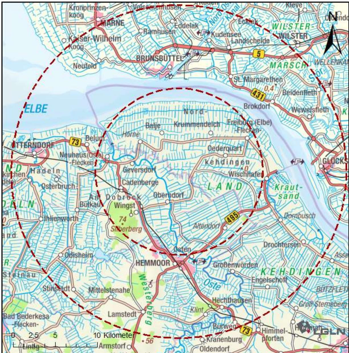
**Abbildung 4:** Bereich im Radius der 50- bis 100-fachen Anlagenhöhe und damit von 10 bis 20 km im Umkreis des Bebauungsplanes, für den sich eine Fernwirkung gem. NLT (2014) für die 9 ca. 207 m hohen Windkraftanlagen<sup>3</sup> ergibt. Maßstab 1: 250.000.
