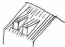
Schlepp- und Giebelgaube
